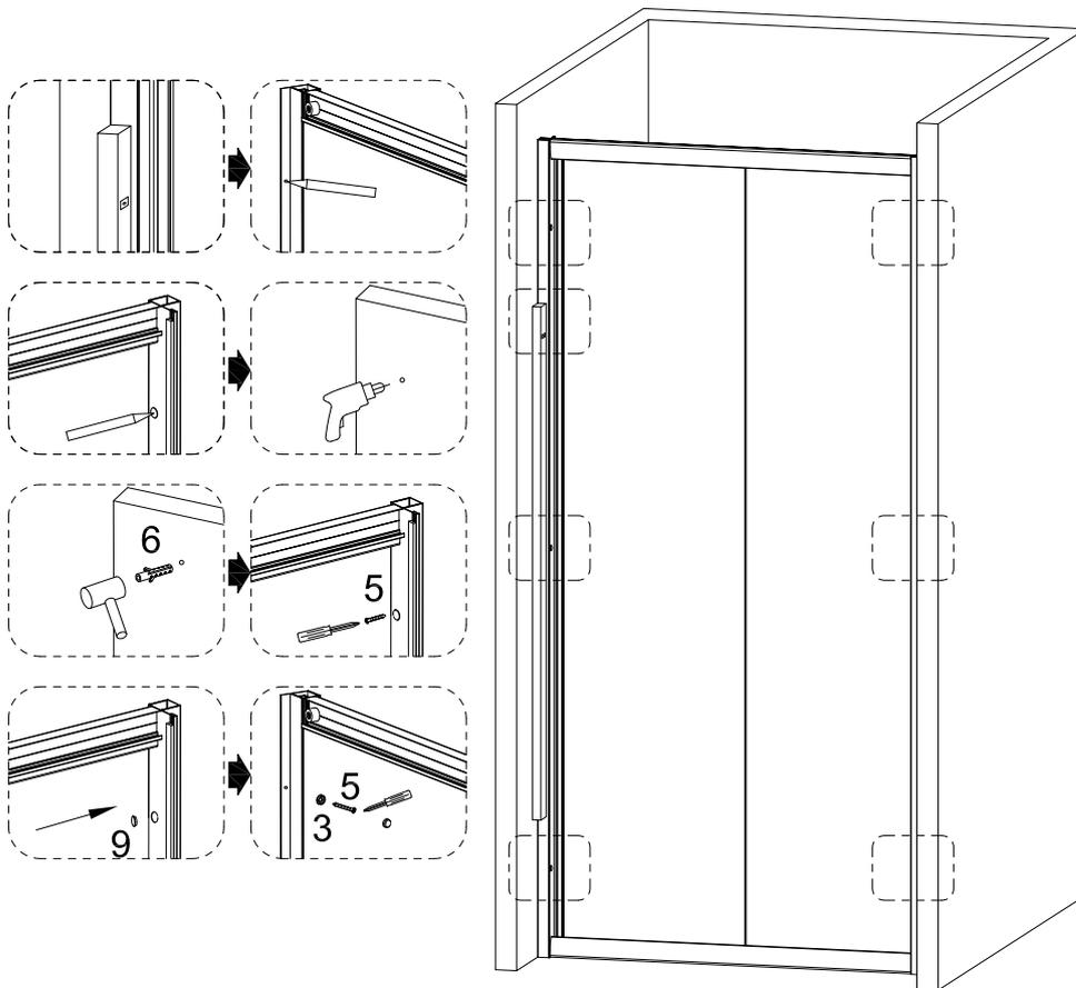
1. Munissez-vous d'un niveau à bulle, puis mettez en place la structure contre les murs, en prenant soin de plaquer les profilés muraux (2 et 11) contre les murs. (possibilité d'ajustement).
