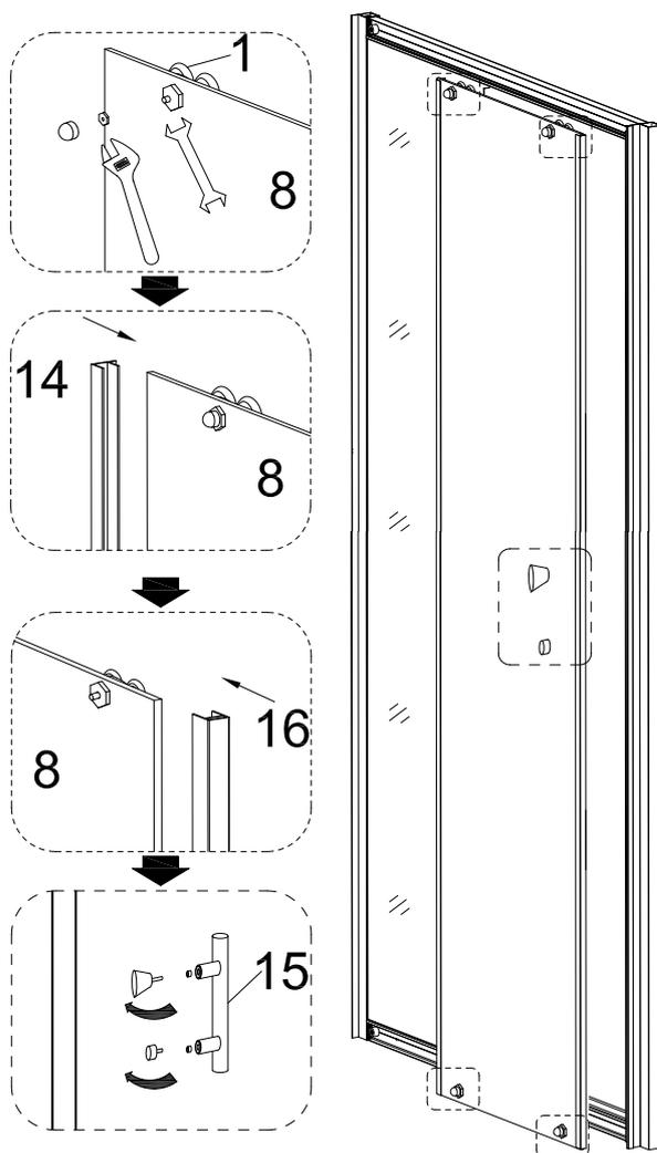
1. Assemblez les roulettes (1) sur la porte vitrée (8) comme indiqué sur le schéma, puis accrochez la porte sur le rail de guidage supérieur (10).
