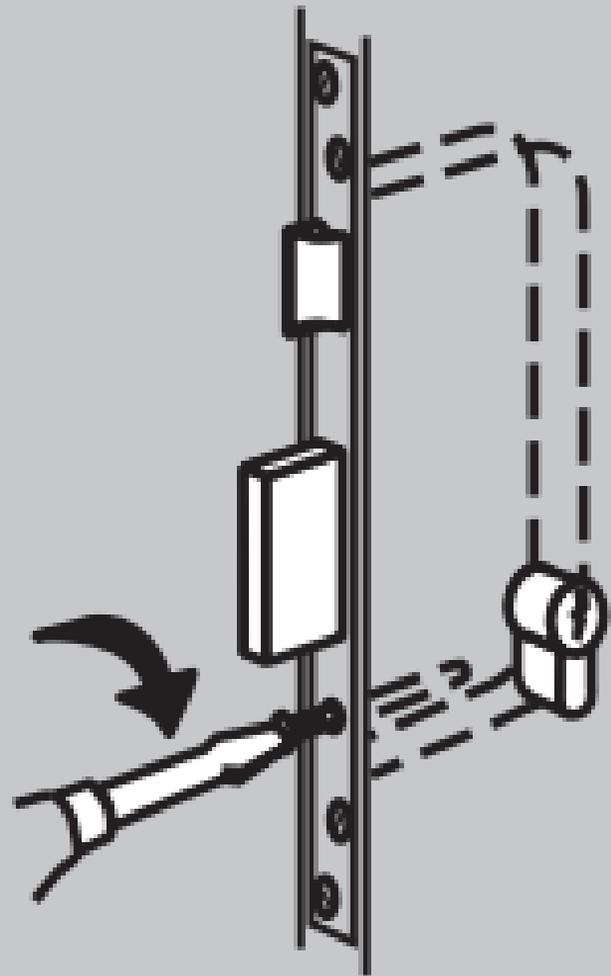
Dévisser la vis existante et retirer le cylindre. Mettre le panneton à l'aide de la clé dans l'axe du corps du cylindre. Placer le nouveau cylindre avec la clé dans la serrure et fixer.
